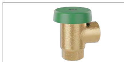
防真空阀用于防止因虹吸现象导致的饮用水管网污染。对于1、2和3类的保护仅限于反向虹吸。不保护背压导致的污染。
