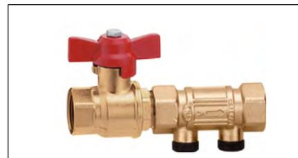
EA型防污止回阀可用于防止最高2类水污染风险。防污止回阀包括阀体(1)、止回阀芯(2)，可能还有一个或多个检测孔(3)，用于系统的运行和排水过程检查。止回阀芯(2)分离出两个不同的区域：一个在上游或入口(A)，一个在下游或出口(B)。
