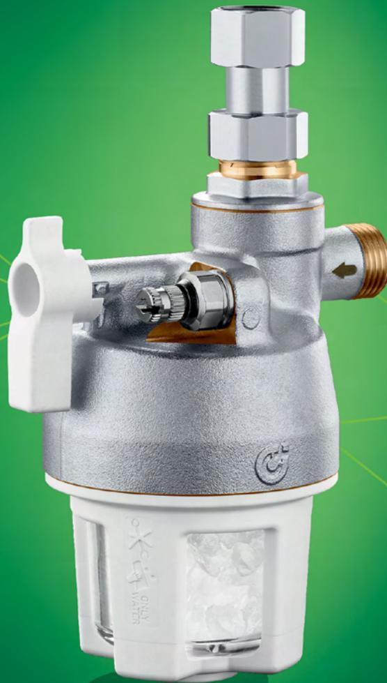
说到健康，我们的选择非常明确。新的**CALEFFI XP 5459**型硅磷晶除垢阀可以保护卫浴热水系统，又不影响水的可饮用性，这要归功于准确剂量的多磷酸盐晶体。精确而高效，一次加药用时长久。
