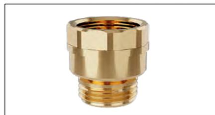
防真空阀运用于大气相通并带有浸水软管的卫浴系统。对于第三类的保护仅限于反向虹吸。对背压没有保护作用。
