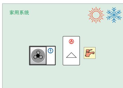
图示3和4与前面图示类似，不同之处在于热水不是即热式的而是储热式的。
