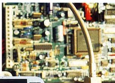
Fase finale dell'assemblaggio è la taratura funzionale del prodotto. I vari sensori aggregati vengono verificati ed elettricamente corretti in base ai valori di pressione, portata temperatura generati da strumenti campione.
