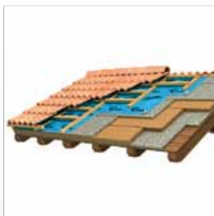
屋顶瓦下面保温
