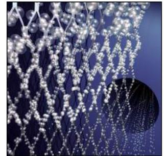
气泡大量聚集在金属网端由于体积增大而脱离金属网上升到排气舱，排气舱上端有自动排气阀浮球②将空气排出。微泡排气阀的设计使其不受水流方向的影响。
