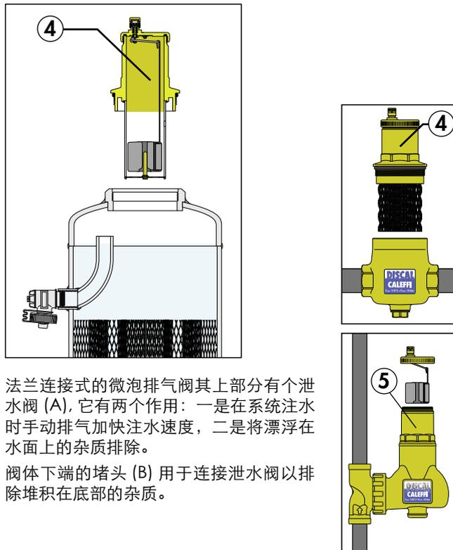
法兰连接式的微泡排气阀其上部分有个泄水阀 (A)，它有两个作用：一是在系统注水时手动排气加快注水速度，二是将漂浮在水面上的杂质排除。
