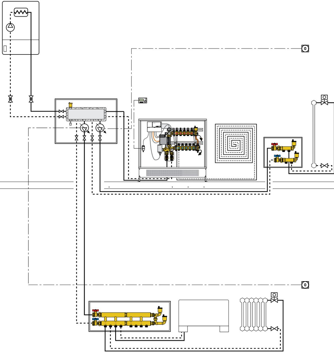
壁挂炉供暖，3+1型水力分压集分水器的运用图示
