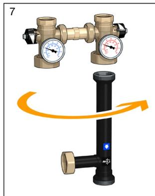
将HE2型号为UPML 25-105高效泵头的4个螺钉拧掉，逆时针旋转泵头90°再装回泵座上，如不按此指示无法装回保温壳内。HE1型号无需操作。
