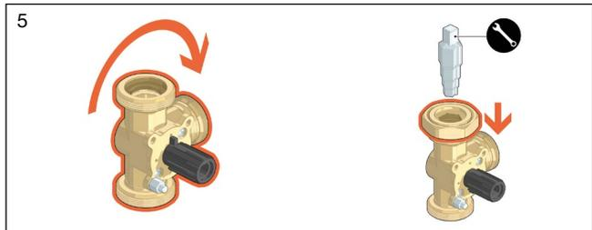
6. 手动旋转混合阀到指定刻度。
