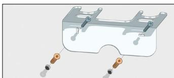
温控中心的内六角螺纹接口下端有卡槽，直接卡入支架即可。
