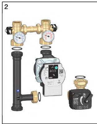
3. 将混合阀的电机取下。
