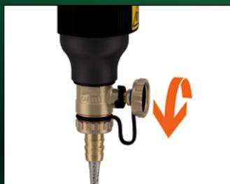
将磁环取掉，用泄水阀盖打开泄水阀即可排出杂质，系统运行时仍可排污。
