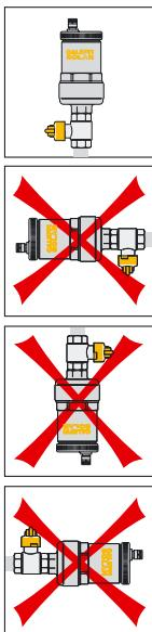
Le valvole di sfogo aria automatiche DISCALAIR serie 251 devono essere installate in posizione verticale, tipicamente sulla sommità dei pannelli degli impianti solari e nei punti del circuito dove si raccolgono le bolle d'aria che devono essere scaricate.
