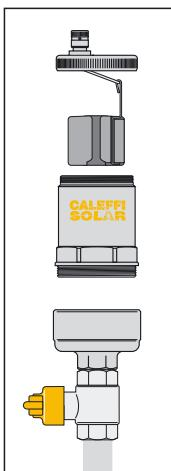
La valvola di sfogo aria automatica DISCALAIR è costruita per permettere di effettuare il controllo del meccanismo interno.
