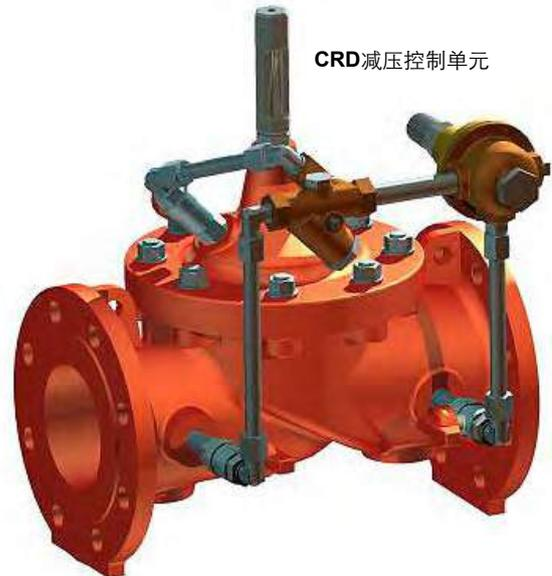
CRD减压控制单元无论流量和/或入口压力如何变化，CLA-VAL90系列将入口处较高的压力减小至恒定的下游压力(减压控制单元)。
