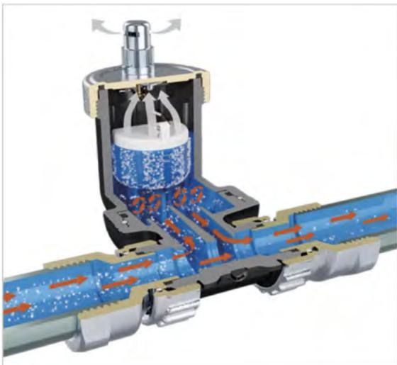
DISCALSLIM 紧凑型微泡排气阀其内部的结构可将排气舱内的水流分开。在此排气舱内水流速度放缓，水流由二次排气舱内的翅片分开，形成涡流。由于形成了这些小漩涡，水流中的微泡气体得到分解，聚积到排气舱下部，形成较大的气袋，并通过浮球一侧的排气管向上排出。一旦聚集的气袋到达阀门顶端，便推动浮球向下运动，打开排气阀排出气体。
