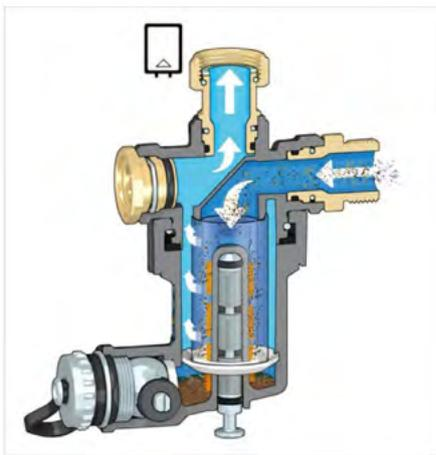
滤网内有一个内置的磁棒，磁棒与水流没有直接接触，它产生的磁场将铁锈类杂质吸附在滤网中间的磁棒护套上。
